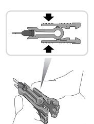
Пинцет для извлечения предохранителей расположен в блоке предохранителей в салоне. Возьмитесь пинцетом за головку извлекаемого предохранителя (показано на рисунке), зажмите ее середину (как указывают стрелки) и потяните. Разрыв проволочки в предохранителе означает, что предохранитель перегорел.
