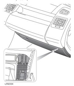
Блок предохранителей в салоне установлен позади перчаточного ящика. Для доступа к предохранителям откройте перчаточный ящик, сожмите верхние части опорных стоек и опустите ящик в нишу для ног.
