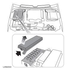
Снимите пластиковую крышку, нажав на язычки.
