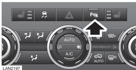
При управлении автомобилем в ограниченном пространстве система помощи при парковке передним ходом может быть включена вручную нажатием выключателя на центральной консоли (показан стрелкой).
