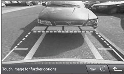
При выборе заднего хода сенсорный экран автоматически отображает вид области позади автомобиля.
