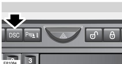
Для отключения системы DSC нажмите и немного придержите переключатель DSC (указан стрелкой) на панели приборов (световой сигнал DSC будет гореть непрерывно). Кроме того, отключение DSC сокращает уровень вмешательства электронной противобуксовочной системы и может привести к увеличению пробуксовки колес.
